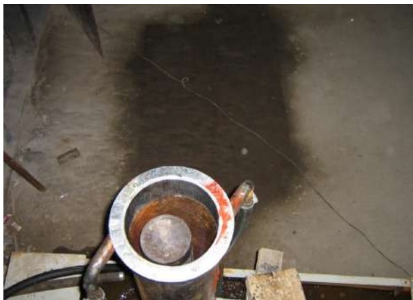
Рис. 3. Внешний вид процесса взаимодействия горящего факела топлива в контакте с потоком жидкости по внутренней поверхности цилиндра (Вид сверху)
